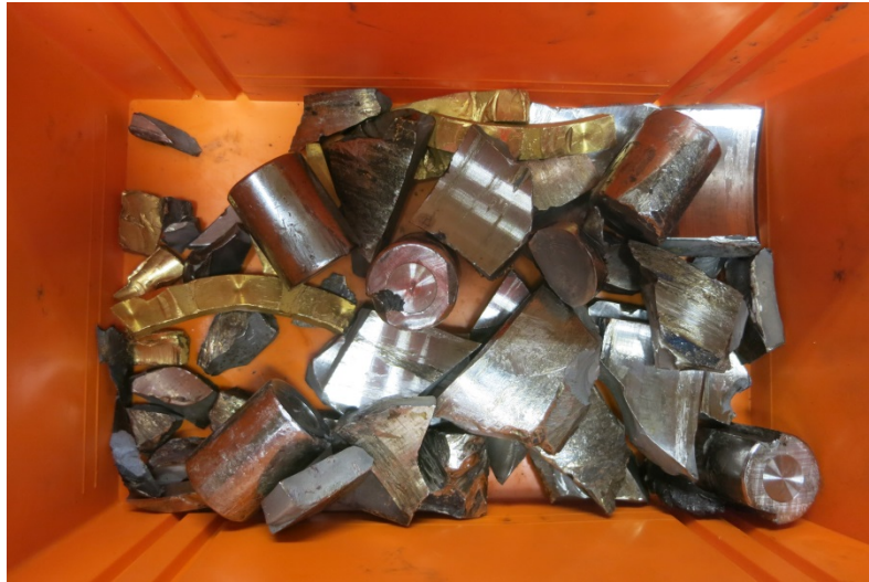
Geborgene Teile aus zerstörtem Walzenlager
